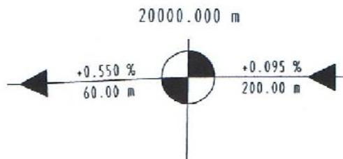
Neigungsbrechpunkt mit Angabe von Gefälle (-) und Steigung (+) in Prozent, Länge der Gefälle-(Steigungs-) Strecke und Halbmesser.
