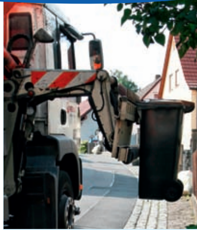
Moderne Müllautos greifen die Tonnen vollautomatisch
